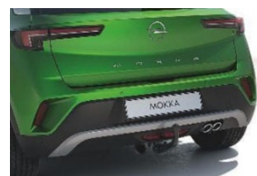
Szerszám nélkül leszerelhető vonóhorog 13 pólusú csatlakozóval
