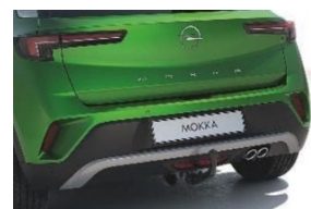
Szerszám nélkül leszerelhető vonóhorog 13 pólusú csatlakozóval
